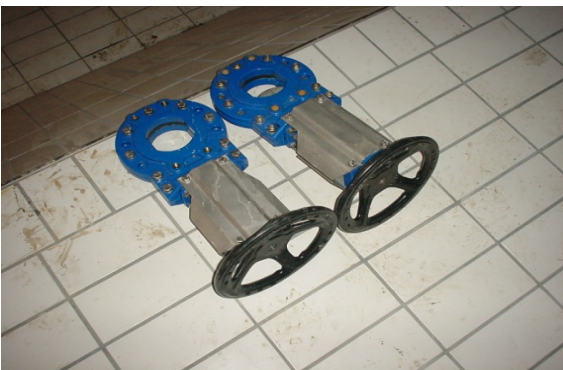
Schieber Foto während der Bauphase
